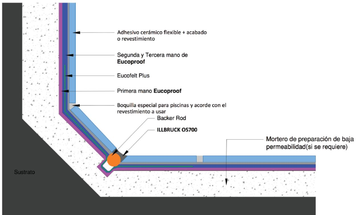
Figura 4. Detalle de juntas y aplicación del sistema.
