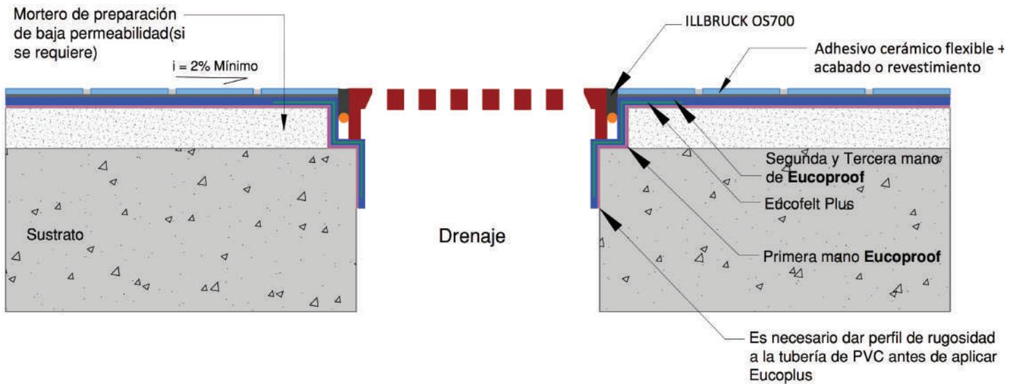
Figura 3. Detalle de desagüe
