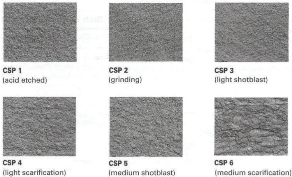
**Figura 2. Perfiles de rugosidad según ICRI**
