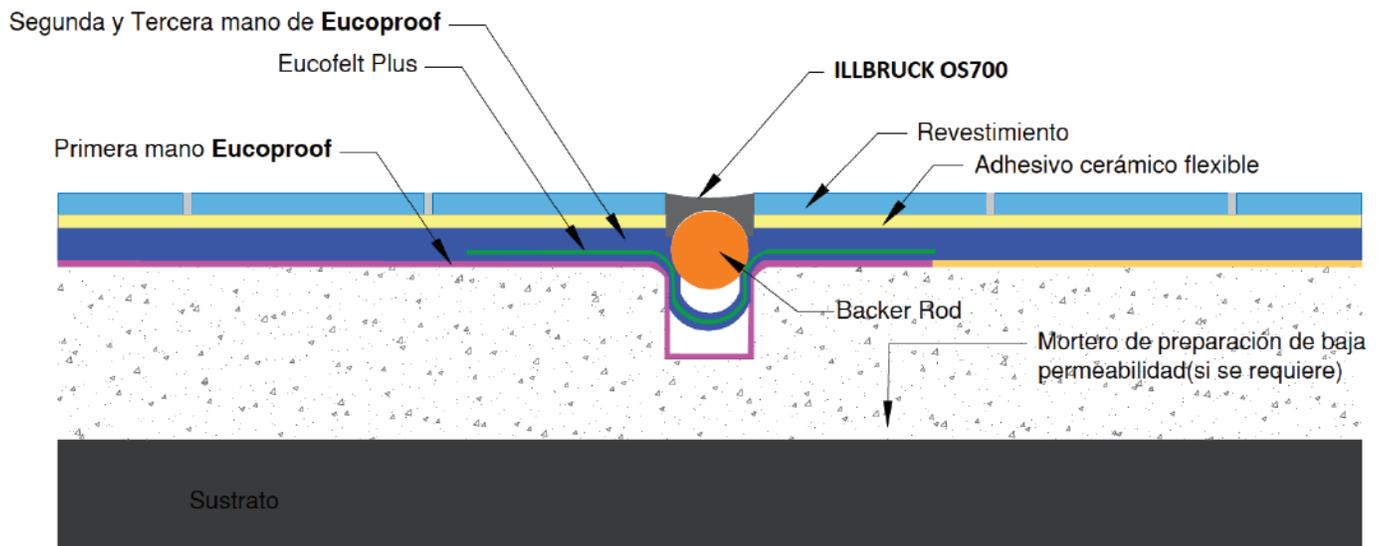
**Figura 5. Esquema general de impermeabilización y juntas.**
