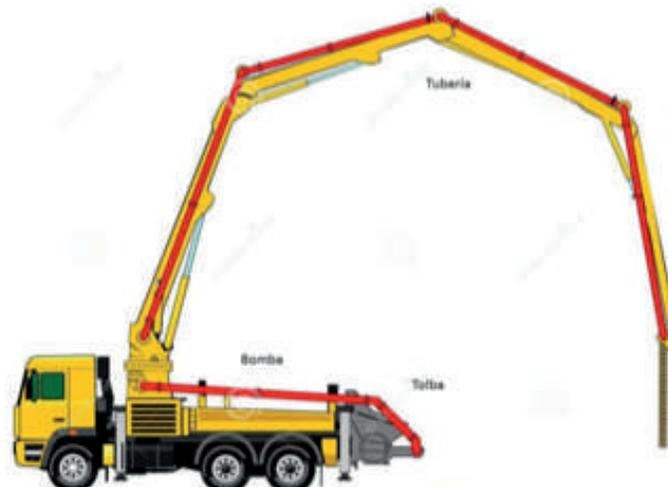
Las autobombas pueden variar el tamaño del brazo de 17 m a 63 m, mientras las bombas estacionarias pueden bombear a distancias horizontales entre los 40 m a los 300 m, aunque se han realizado bombeos record de 2.015 m en Le Refrain (Francia). En sentido vertical pueden bombear hasta 100 m en condiciones normales pero se han alcanzado los 606 m en las torres del Burj Dubai en los Emiratos Árabes Unidos.
