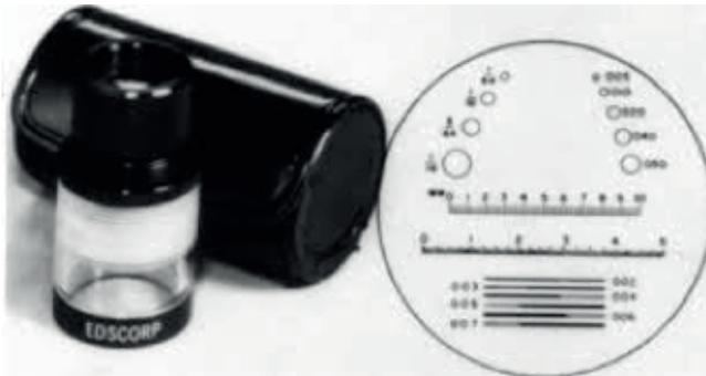
*Microscopio comparador de fisuras.*
