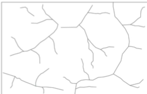
Figura 13. Representación de fisuración por ataque de sulfatos Fuente: FOPAE, 2011.
