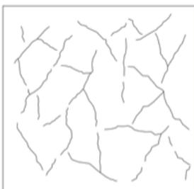
Representación típica de fisuración por retracción plástica
