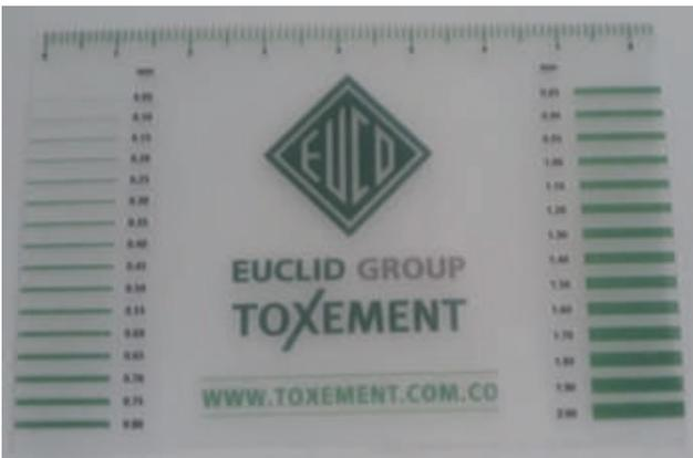
*Tarjeta de comparación de fisuras*
