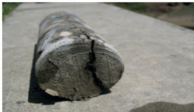
*Tomo de núcleos para verificar profundidad de fisuras*
