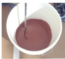
Adición del pigmento P/D (30 seg / und)
