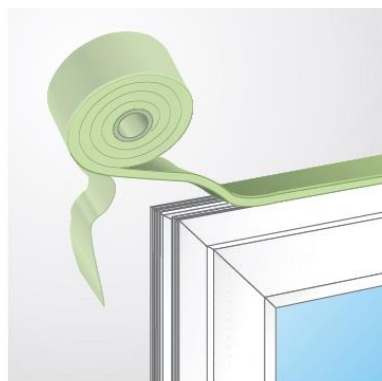
Figura 3: colocación en un solo paso
