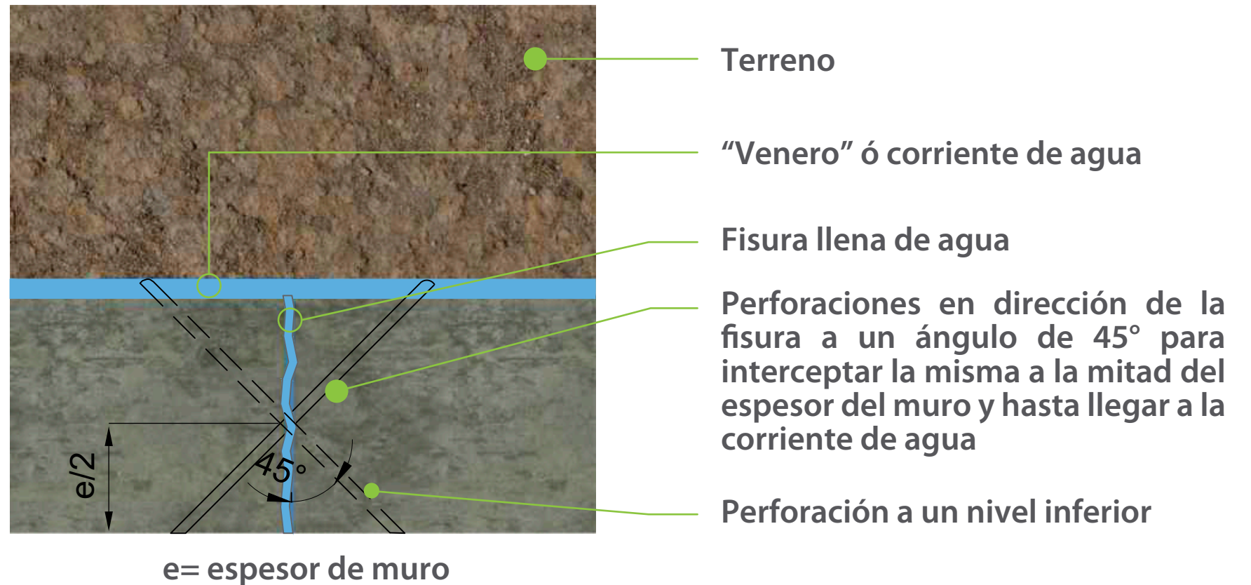
Figura 6. Vista en corte superior – Perforaciones a 45° atravesando la fisura y llegando hasta el “venero” o corriente de agua.
