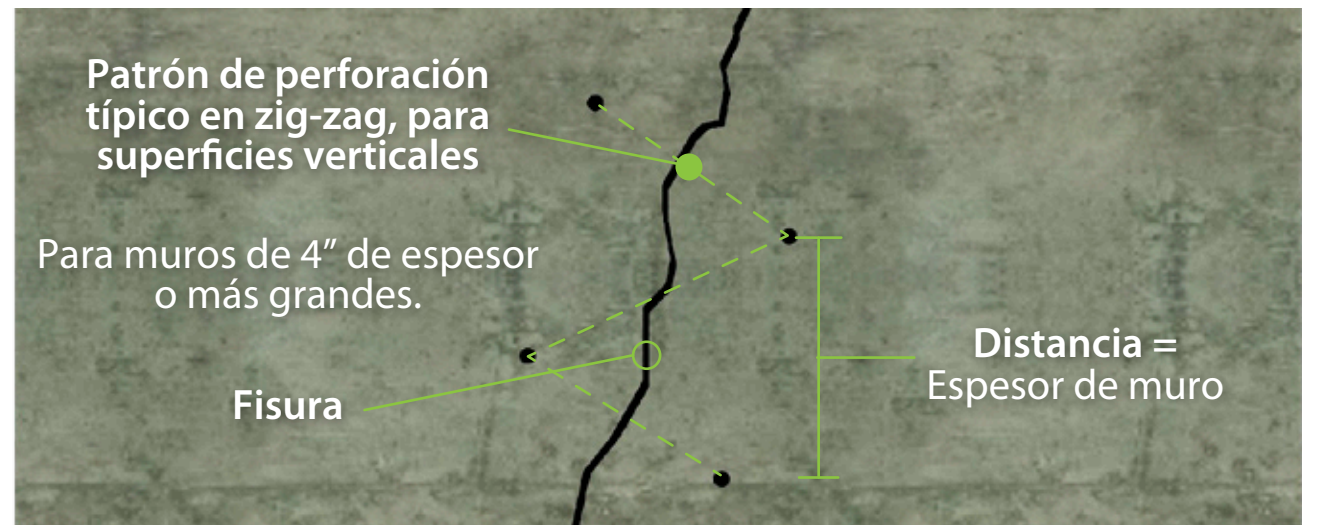
Figura 2. Perforaciones para hacer inyección con grouteo químico de la línea DURAL AQUA-DAM
