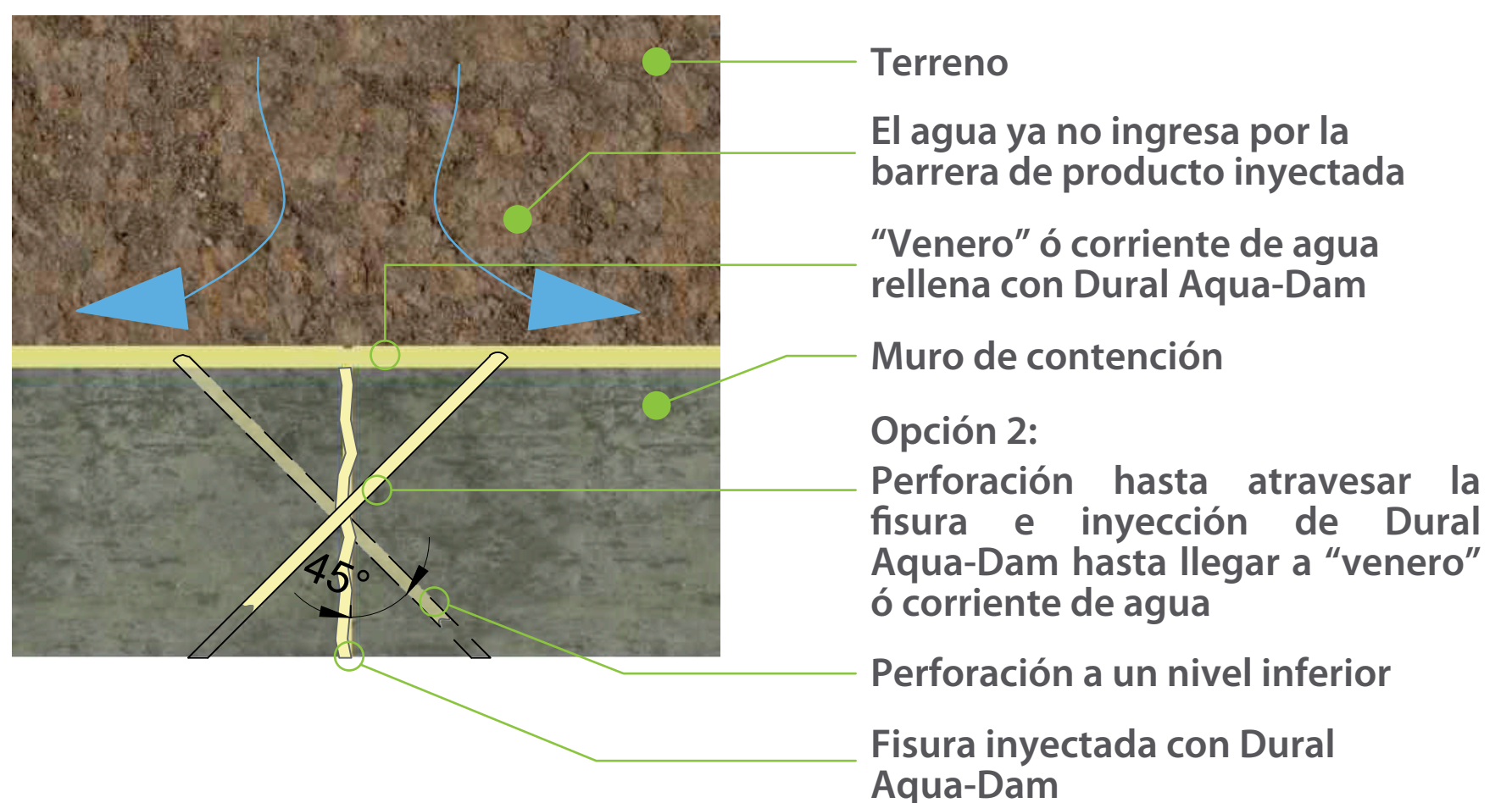
Figura 7. Vista en corte superior – inyección con Dural Aqua –Dam restringiendo el paso del agua por la fisura y por la corriente agua entre el muro y el terreno.
