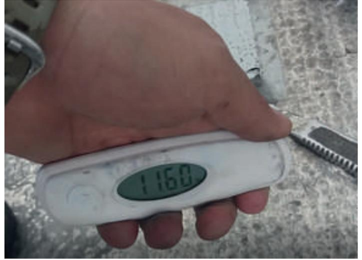
VII. Apunte los valores registrados por la balanza y divida este valor entre el diámetro de la banda de PERMAFAB. El resultado debe ser mayor a 2 lb/in, la falla debe ser cohesiva
