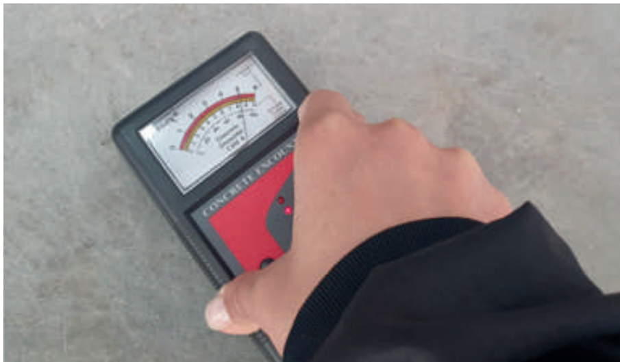
Figura 3. Determinación de humedad en placa de concreto
