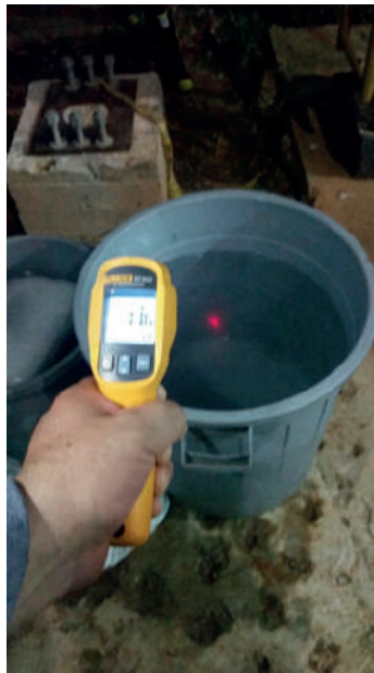
Control de la temperatura del agua
