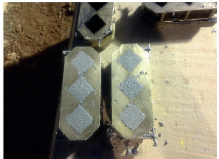
Toma de muestras de grout epóxico en cubos 50 mm para ensayo según ASTM C579.
