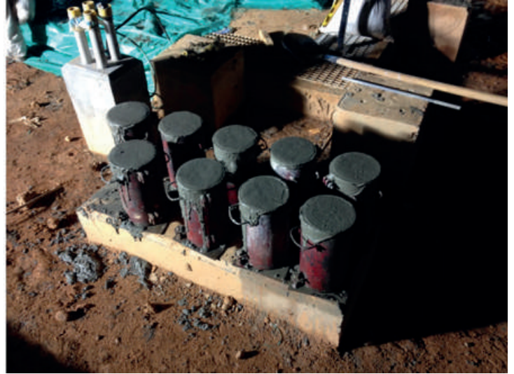
Toma de muestras de grout cementicio con gravilla en cilindros para ensayos según ASTM C 39.
