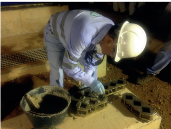
Toma de muestras de grout epóxico en cubos 50 mm para ensayo según ASTM C579.
