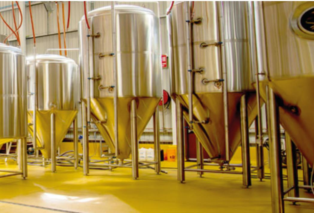
Se instalaron 600 m<sup>2</sup> del Flowfresh SR antideslizante en diferentes espesores en las áreas de servicio pesado de la cervecería en Warm Buff. Estas áreas requerían un sistema robusto, que manejara ácidos y productos químicos de limpieza y los cambios térmicos asociados con la fermentación y estrictos controles de higiene.
