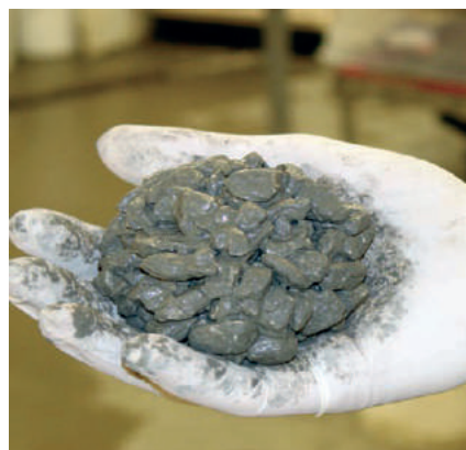
Aspecto del concreto poroso en estado fresco
